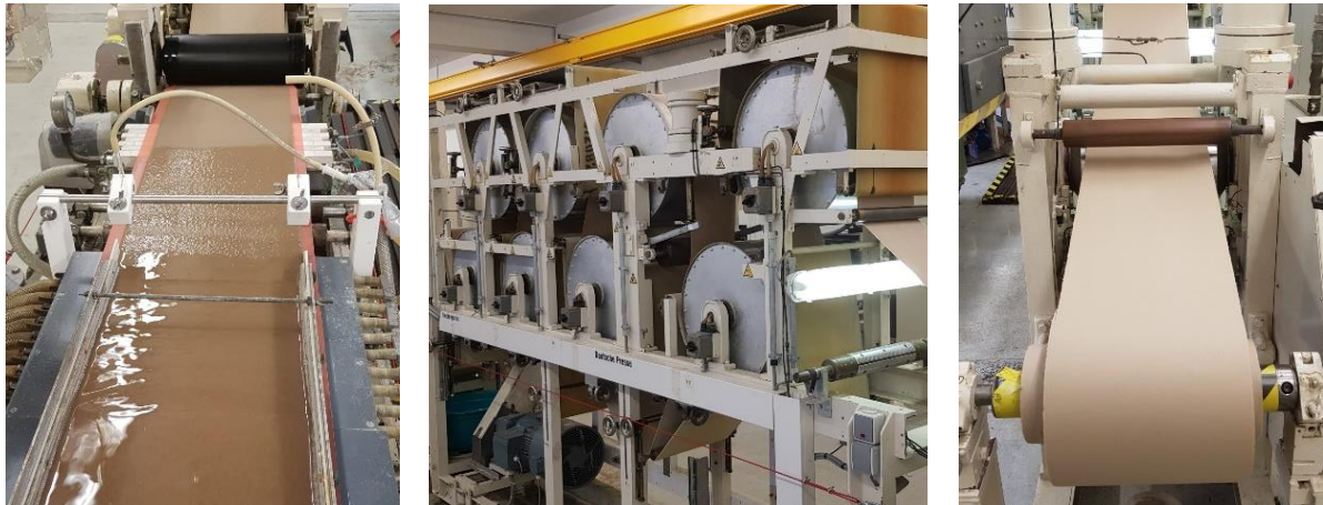
Abbildung 3-9: Links: Stoffauflauf mit Vakuumbesaugung und erster Press (schwarze Walze). Mitte: Trockenpartie. Rechts: Aufrollung
