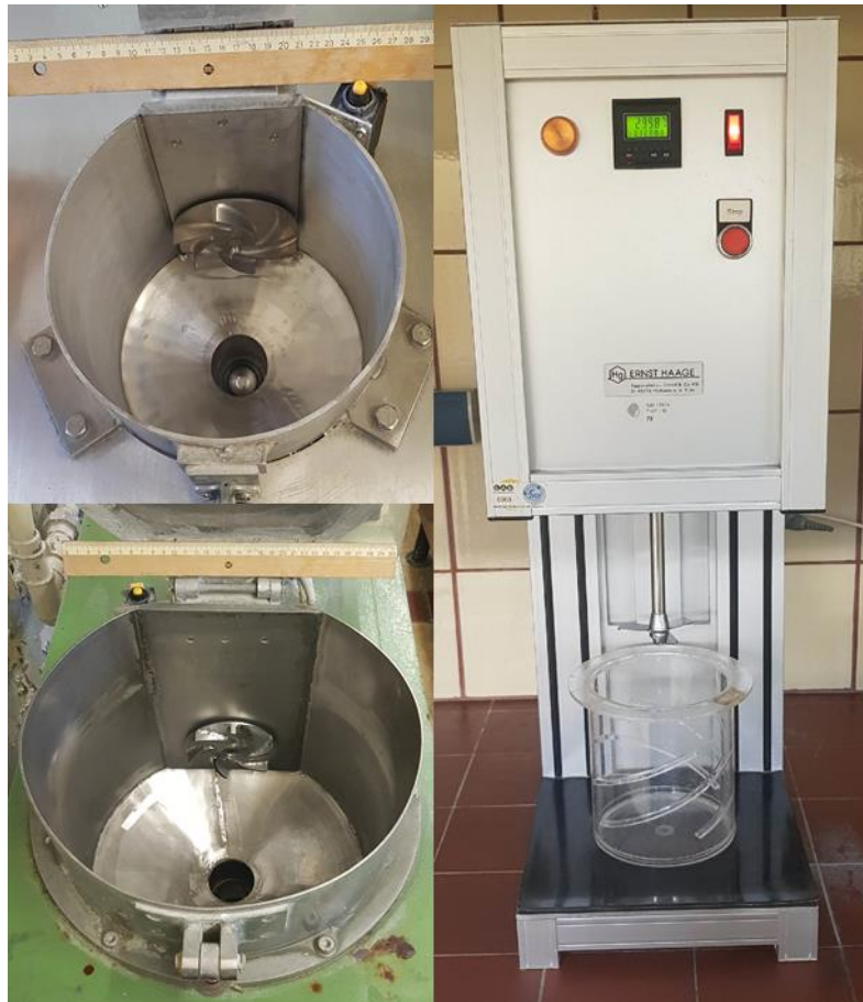
Abbildung 3-2: Oben links: Nachbau des LC Pulper mit 8 l Fassungsvermögen; Unten links: LC-Pulper mit 19 l Fassungsvermögen; Rechts: Standarddesintegrator
