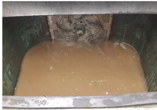
Abbildung 3-7: Pulper der Firma Voith in der Stoffaufbereitung des PMV
