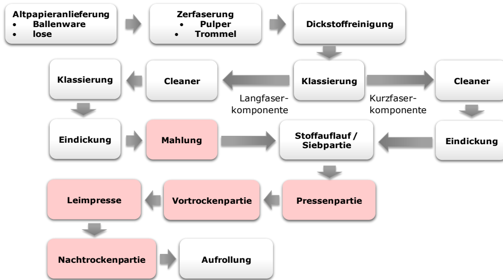
Abbildung 2-1: Prozessschema zur Herstellung von Wellpappenrohpapier auf Altpapierbasis
